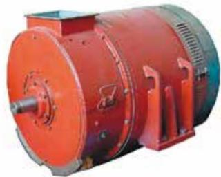
Серия тяговых синхронных генераторов типа СГТ предназначена для питания через выпрямительную установку тяговых электродвигателей карьерных самосвалов БелАЗ. СГТ-1000 – грузоподъемность самосвалов 129-136 т СГТ-1400 – грузоподъемность самосвалов 220 т
