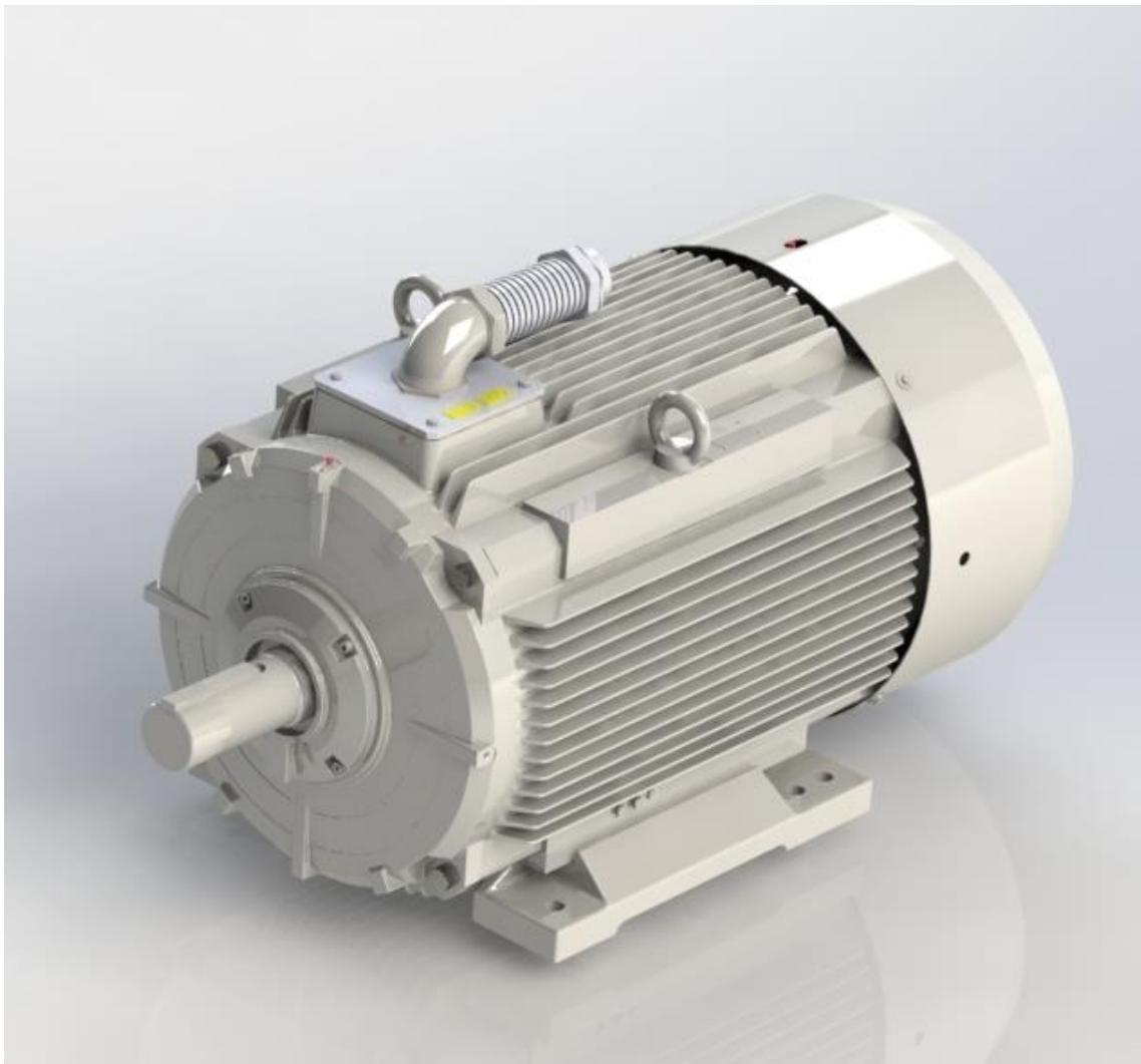
Трёхфазные электродвигатели с короткозамкнутым ротором для применения в оборудовании для отвода дыма и тепла по DIN EN12101-3, класс F400. Электродвигатели разработаны на основе базовой конструкции серии A/RA с применением специальной системы изоляции, подшипников со специальной смазкой и технологии подключения питания.
